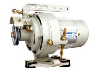
DOL12H 离合电机 Clutch motor DOL13H 250W 2P 2850RPM DOL13L 250W 4P 1425RPM DOL12H 400W 2P 2850RPM DOL12L 400W 4P 1425RPM DOL34H 550W 2P 2850RPM DOL34L 550W 4P 1425RPM
